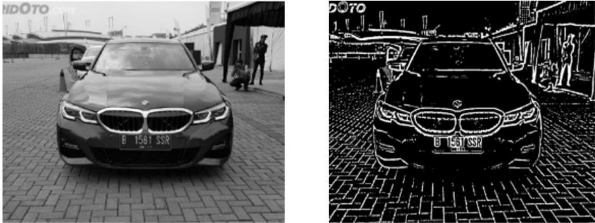
Gambar 5. Gambar Grayscale sebelum dan setelah diubah menjadi Adaptive Thresholding
