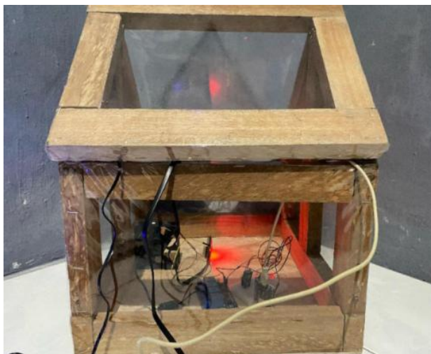
Gambar 2. Rangkaian sensor suhu dan kelembaban
